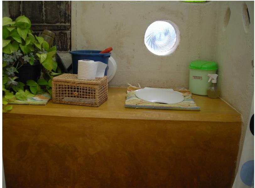
O sistema de comunicação entre a parte interna e as câmaras que ficam do lado de fora acontecem por uma rampa como mostra na figura abaixo. Nesse tipo de sistema utiliza-se a serragem a cada vez que se utiliza o banheiro. A serragem ajuda no cobrimento das fezes e no processo de compostagem.
