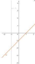
O gráfico parece não ter interrupções, mas na verdade há um ponto de descontinuidade, que não pode ser visualizado (devido às restrições do software de gráficos), quando x=-1.
