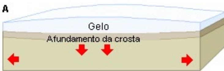
Ilustração simplificada mostra o afundamento da crosta e a volta ao seu nível original produzido pelas diferenças de cargas das geleiras
