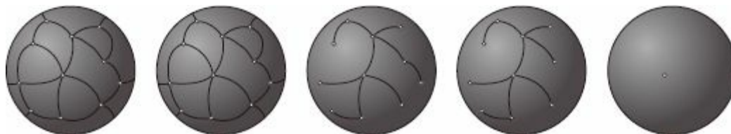
FIGURA 21 Estágios básicos na simplificação de um sólido. Da esquerda para a direita: (1) Início. (2) Fusão de faces adjacentes. (3) Árvore que resta quando todas as faces tiverem sido fundidas. (4) Remoção de uma aresta e de um vértice da árvore. (5) Fim.
