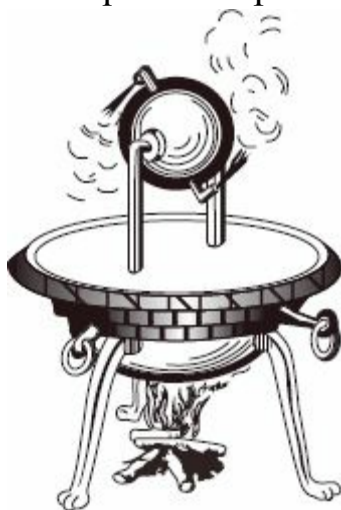
FIGURA 46 A eolípila de Heron.
