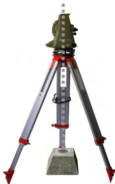
**Figura 6.35 - Eixo principal do equipamento passando pelo ponto.**
