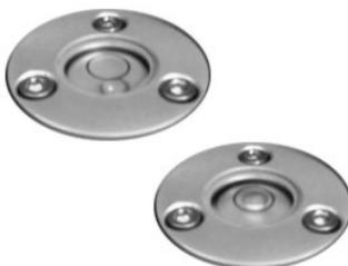
**Figura 6.39 - Calagem da bolha do nível esférico.**
