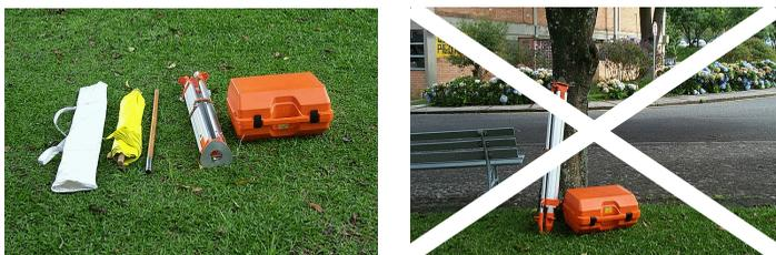
**Figura 6.29 - Disposição dos equipamentos enquanto não utilizados.**
