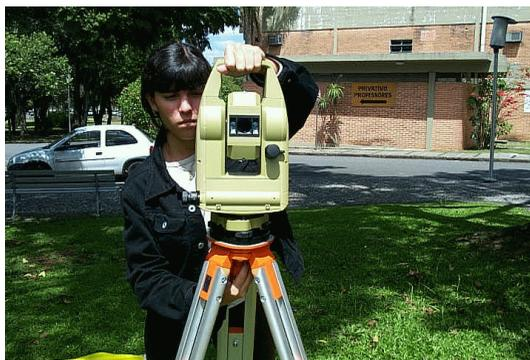
**Figura 6.34 - Fixando o equipamento ao tripé.**
