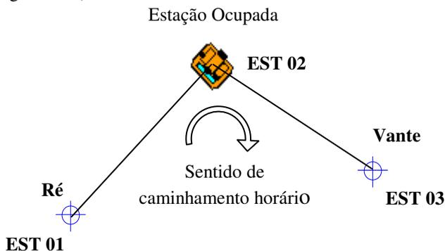
**Figura 9.14 - Estação ré e vante.**
