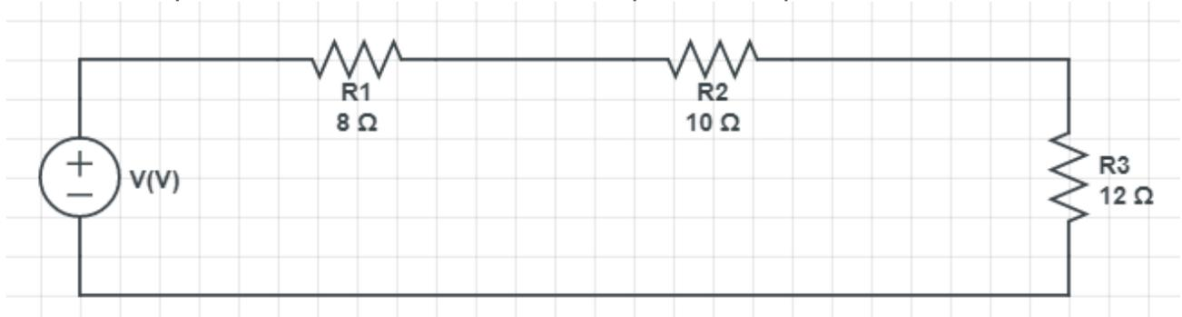
Figura 03: Circuito Série Exemplo para cálculo da Resistência Equivalente.
